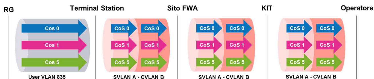
Figura 19 - Modello VLAN Multi CoS
